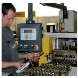
Rohrbiegemaschine für die WÜ-Fertigung
