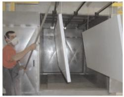
Pulverbeschichtung der Paneelschalen und Komponenten bei 200°C
