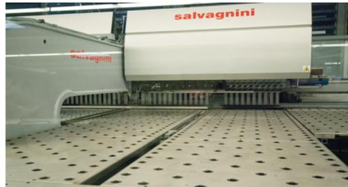
Vollautomatisches CNC-gesteuertes Kant- und Biege-Center
