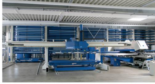
Computergesteuertes Hochregallagersystem und CNC-gesteuerte Stanzanlagen mit automatisierter Stanze
