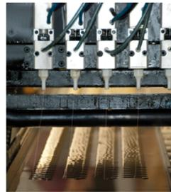
Automatischer Auftrag des Klebers in die Paneelemente
