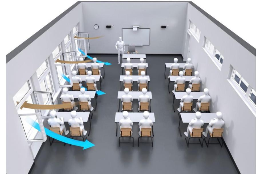
Räume sollten unstreitig mit einer **gesundheitlich zuträglichen Außenluft** versorgt werden. Dabei wird **sauerstoffreiche Luft** dem Raum zugeführt und die **CO<sub>2</sub>-belastete Raumluft ersetzt**.
