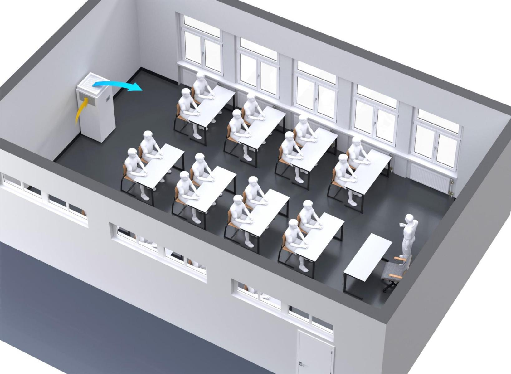
Die **Mischlüftung** (Lüftung mittels **impulsstarker Zuluftstrahlen**, **Vermischung** von **Zuluft und Raumluft**) hat sich unter Fachleuten als praktikable Lösung in Räumen mit **hoher Personendichte** durchgesetzt. Eine raumerfüllende Strömung garantiert eine **homogene Verdünnung der Schadstoffe und deren Abfuhr durch Abluft**.
