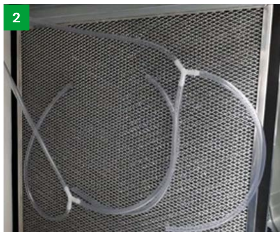
Positionierung der Ausgänge des Aerosolgenerators mit Gleichrichter
