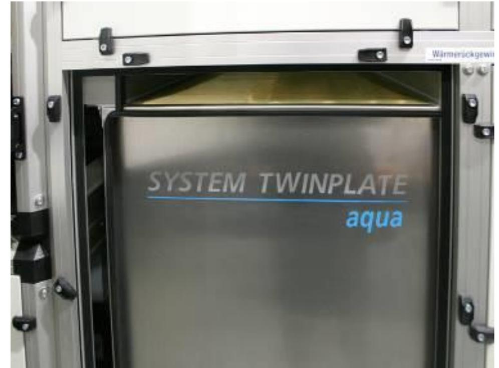
speziell korrosionsbeständiges Aluminium ( $AlMg_3$ ):
